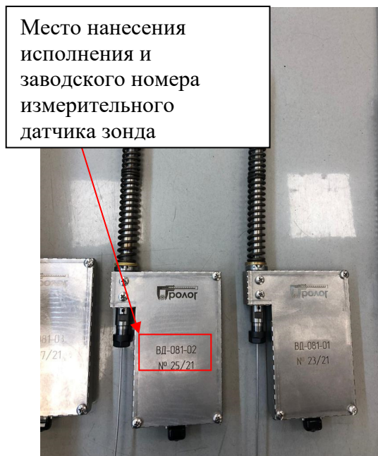
Рисунок 2 - Место нанесения исполнения и заводского номера измерительного датчика зонда
