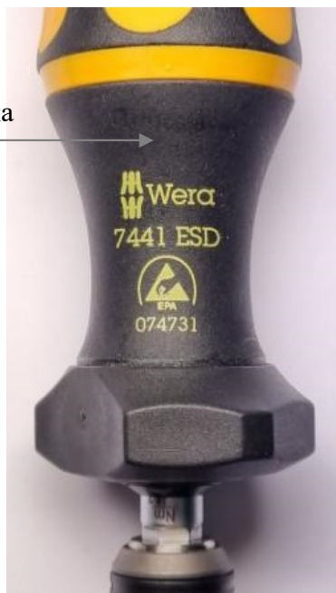
Рисунок 14 - Пример нанесения информации об исполнении, артикуле (а), серийном номере (б) отвертки моментной предельной WERA модификации 7400 Kraftform ESD, 7441 ESD
