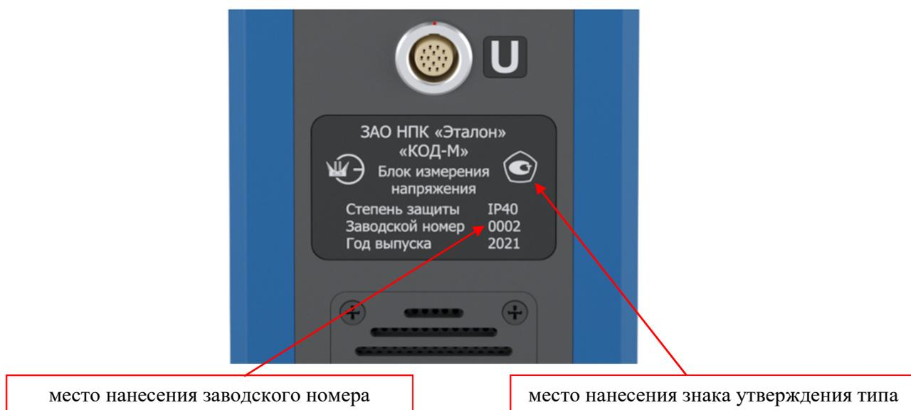
Рисунок 5 – фрагмент задней панели блока измерения напряжения с заводской табличкой
