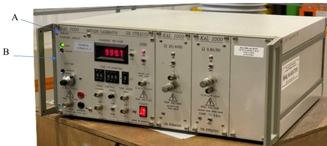
Рисунок 1 – Общий вид калибратора импульсов KAL 1000
