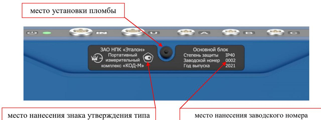
Рисунок 3 – фрагмент задней панели основного блока с заводской табличкой
