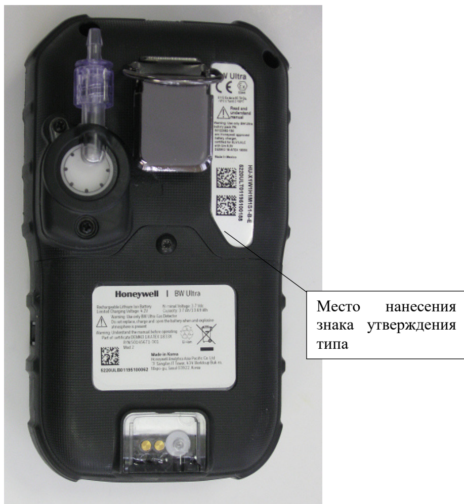
Рисунок 2 – Общий вид задней панели газоанализатора, шильд (наклейка) с указанием заводского номера газоанализатора и места нанесения знака утверждения типа
