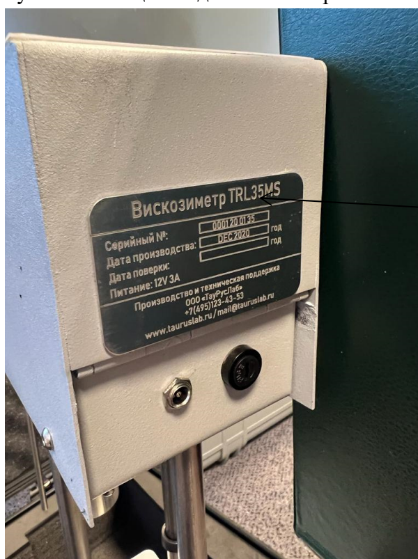
Рисунок 4 – Место нанесения заводского номера на вискозиметр TRL35MS
