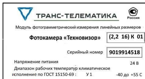
Рисунок 6. Пример маркировочной таблички, фотокамеры «Техновизор».
