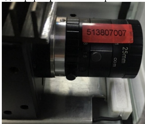
Рисунок 7. Пример пломбировки фотокамеры «Техновизор», с объективом в сборе.
