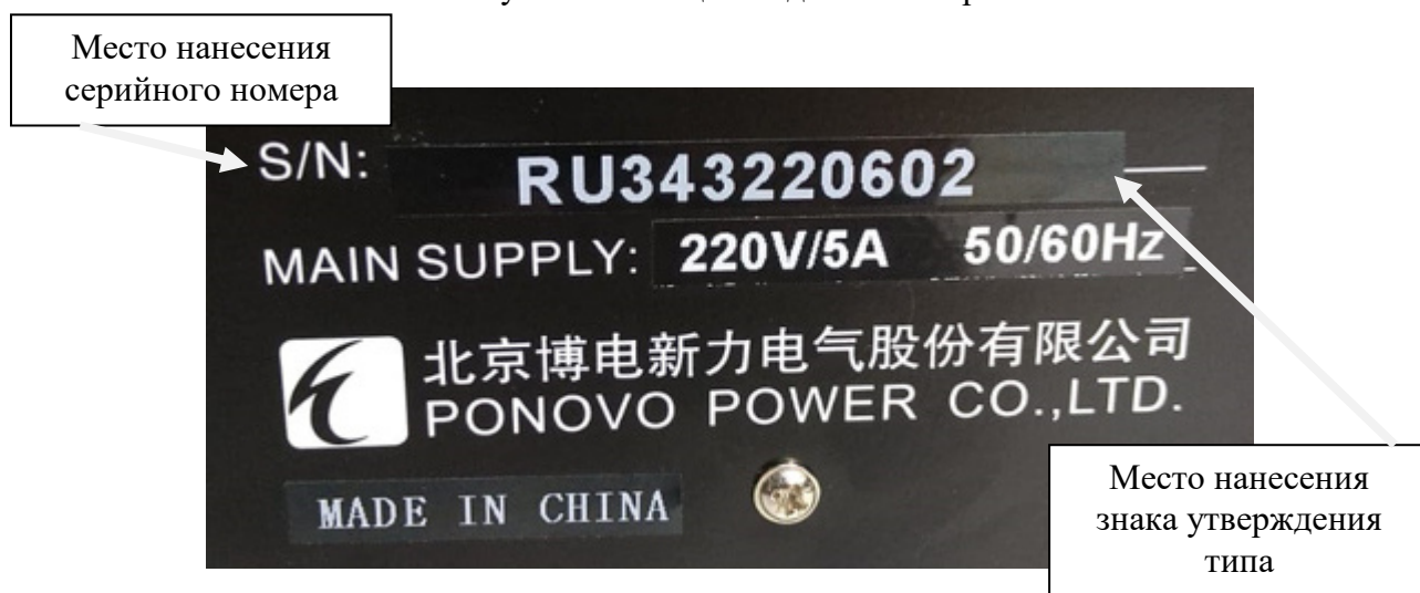
Рисунок 2 – Места нанесения знака утверждения типа и серийного номера
