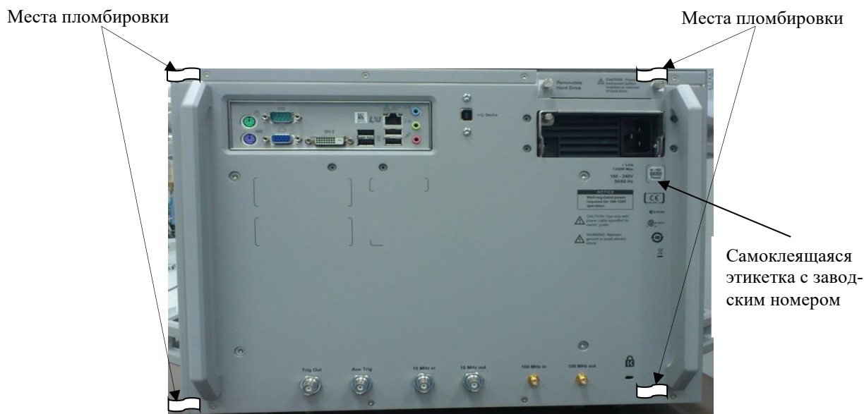
Рисунок 2 - Схема пломбировки от несанкционированного доступа
