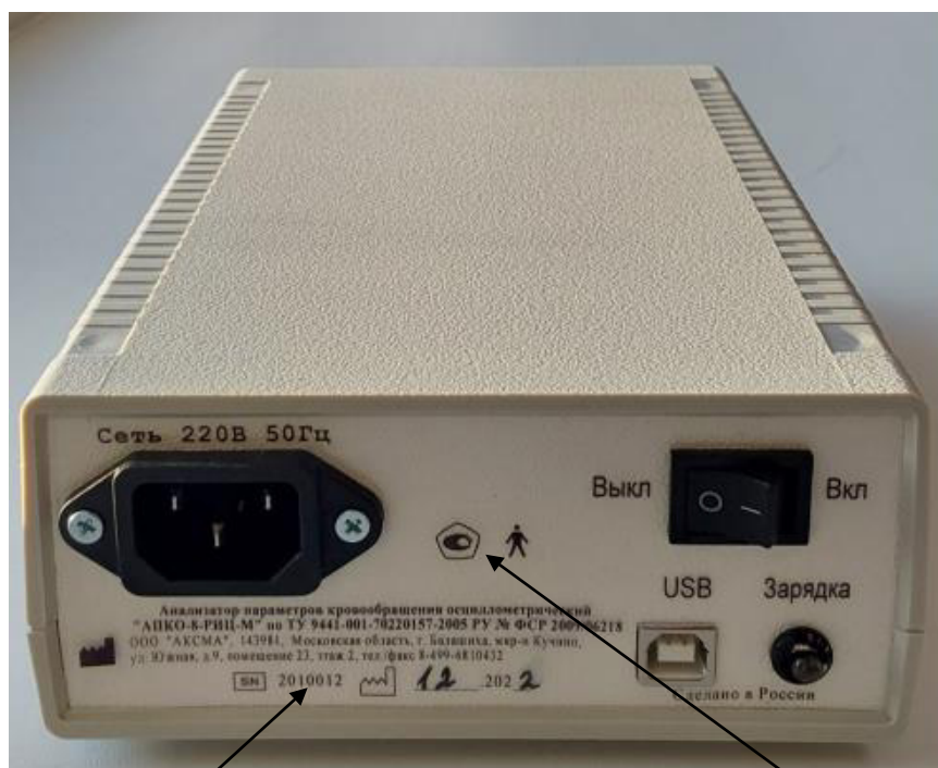
Рисунок 3 – Схема пломбировки анализаторов параметров кровотока осциллометрических АПКО-8-РИЦ-М от несанкционированного доступа
