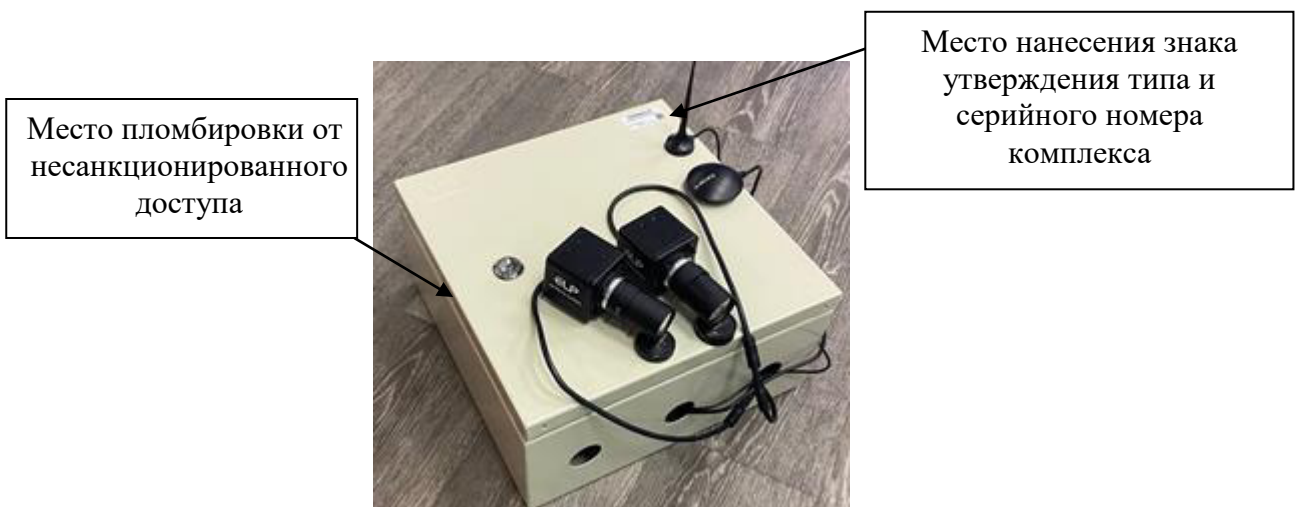
Рисунок 1 – Общий вид блока управления, место нанесения знака утверждения типа и серийного номера комплекса, место пломбировки от несанкционированного доступа
