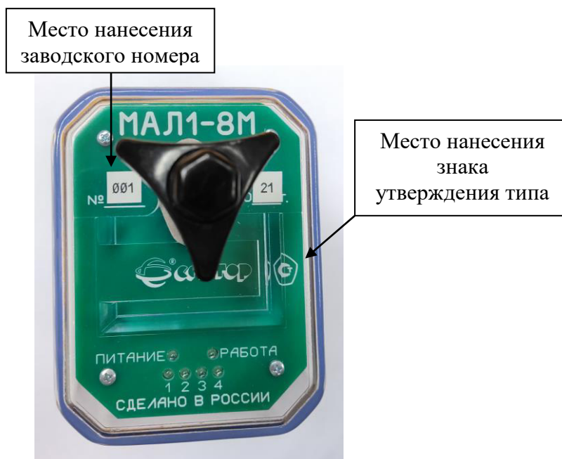
Рисунок 1 – Вид лицевой панели модулей, места нанесения знака утверждения типа и заводского номера
