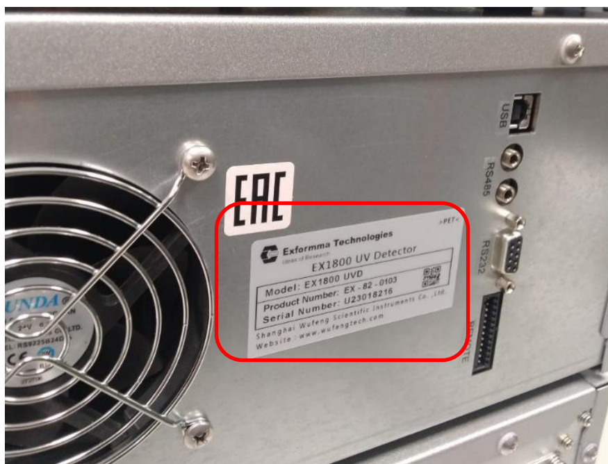
Рисунок 8 – Место нанесения заводского номера блока хроматографов EX1800 на задней части корпуса блока
