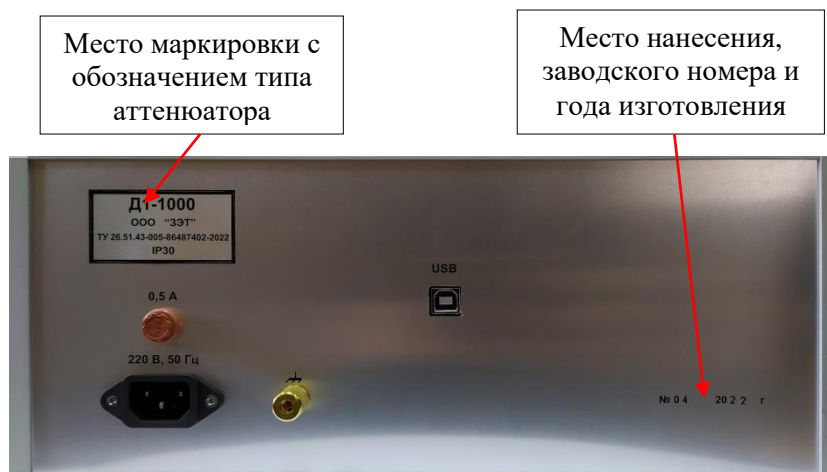
Рисунок 2 – Внешний вид задней панели аттенюатора
