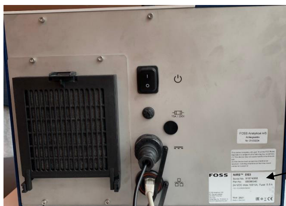
Рисунок 2 – Место нанесения серийного номера на анализаторы зерна, зернопродуктов и комбикормов DS3
