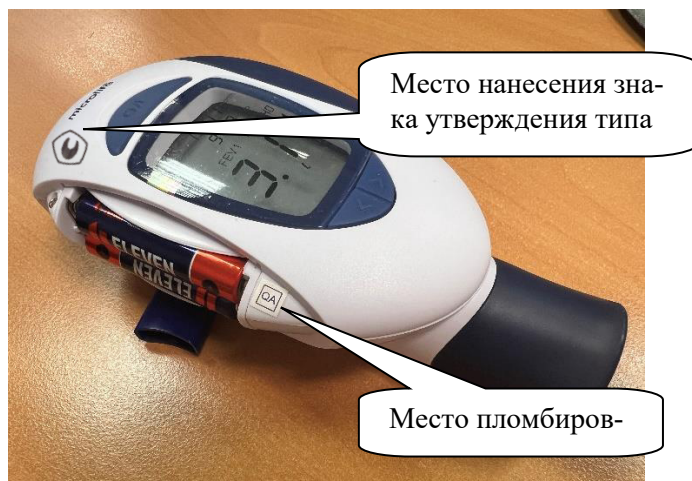
Рисунок 2 – Место нанесения заводских номеров, однозначно идентифицирующих каждый экземпляр средств измерений, место пломбировки и нанесения знака утверждения типа
