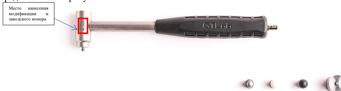
Рисунок 1 – Общий вид молотка ударного модификации 4V301D со сменными наконечниками различной твердости и место нанесения модификации и заводского номера
