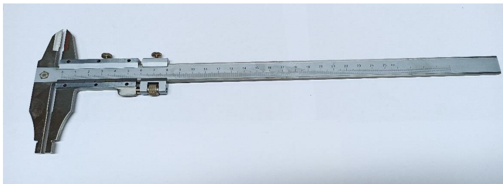
Рисунок 2 – Общий вид штангенциркулей ШЦ типа II
