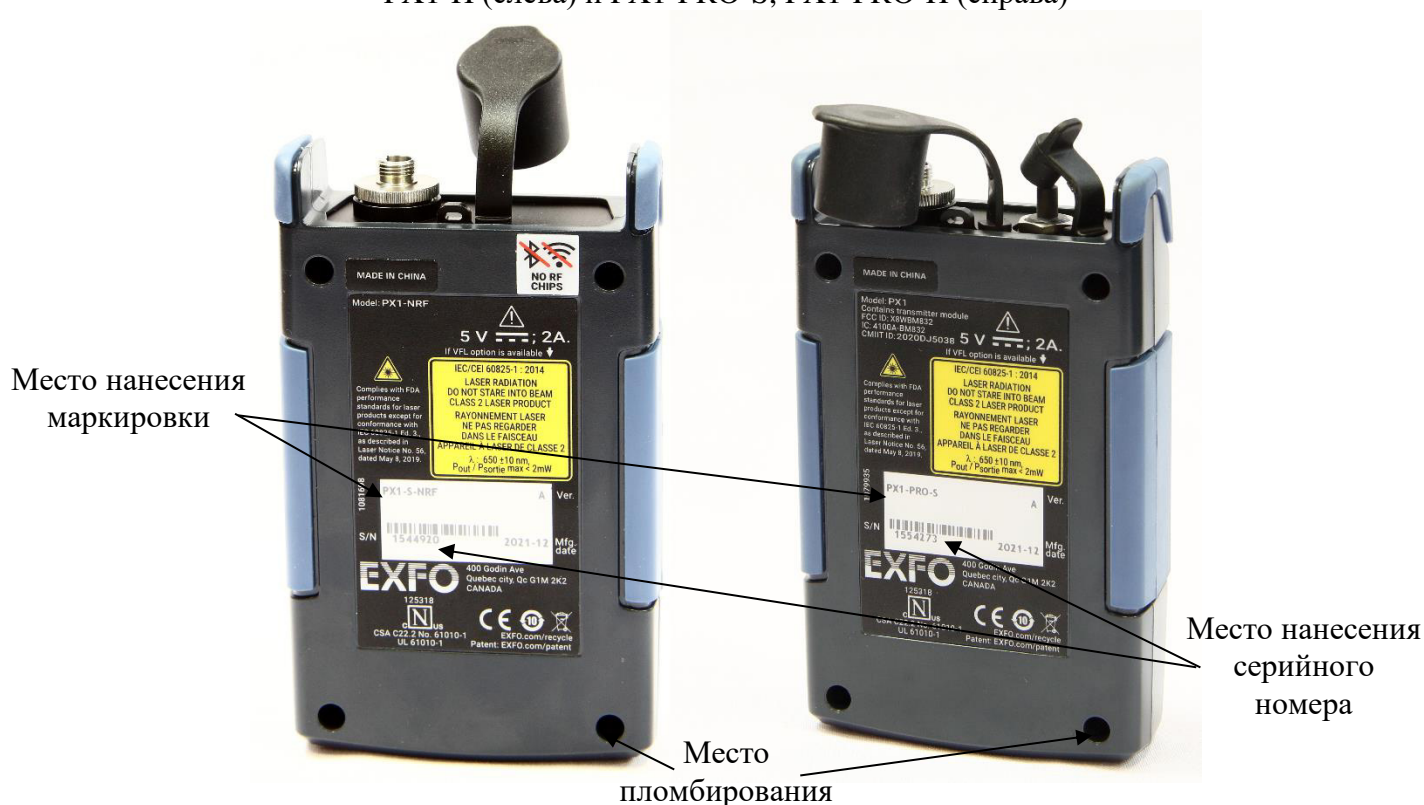
Рисунок 2 – Схема пломбирования от несанкционированного доступа и обозначение места маркировки измерителей оптической мощности Optical Power Expert PX1-S, PX1-H (слева) и PX1-PRO-S, PX1-PRO-H (справа)
