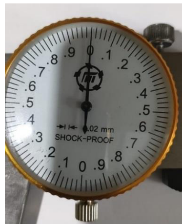
Рисунок 9 – Общий вид круговой шкалы отсчетного устройства штангенциркулей
