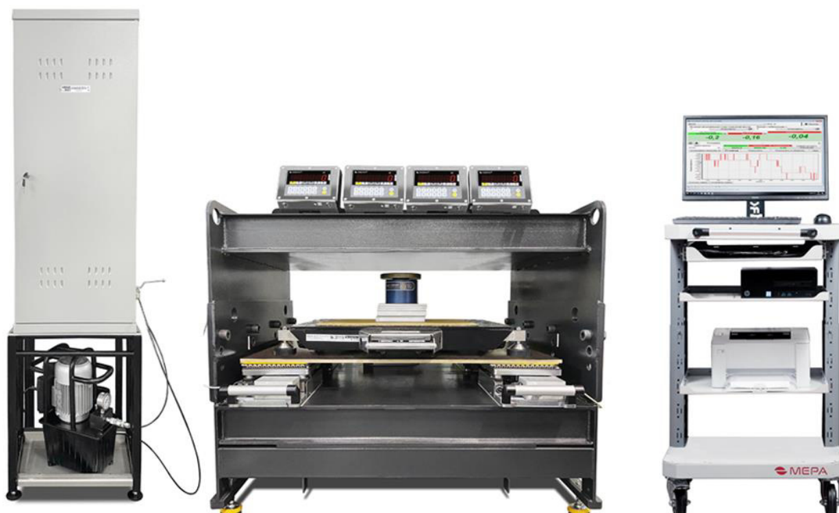
Рисунок 1 – Общий вид Устройства (шкаф-блок с гидropомпой (слева), станция с контрольными весами и гидродомкратом (в центре), управляющий компьютер (справа))
