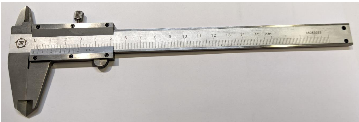
Рисунок 1 – Общий вид штангенциркулей ШЦ типа I
