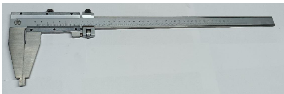
Рисунок 3 – Общий вид штангенциркулей ШЦ типа III
