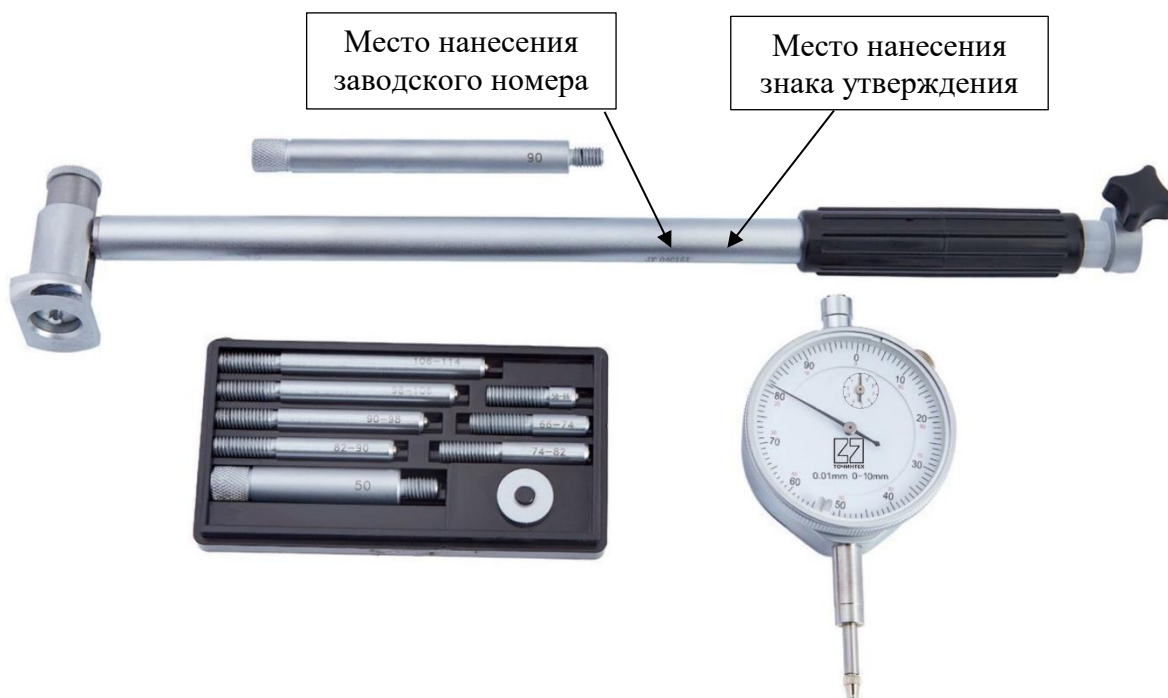
Рисунок 5 – Общий вид нутромеров с указанием мест нанесения заводского номера и знака утверждения типа
