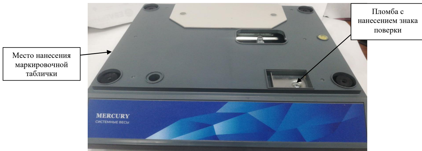
Рисунок 3 – Схема пломбирования весов
