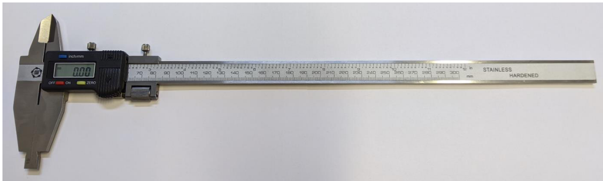
Рисунок 6 – Общий вид штангенциркулей ШЦЦ типа II
