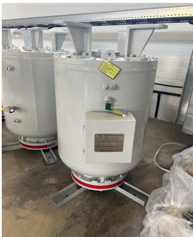
Рисунок 1 – Общий вид трансформаторов напряжения JDQXF-330.
