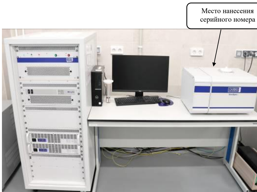
Рисунок 1 – Общий вид ЯМР-релаксометра GeoSpec+2/53, обозначение места нанесения серийного номера
