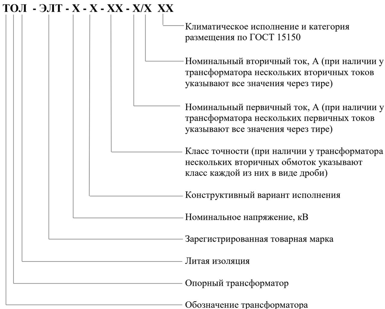
Рисунок 1 – Расшифровка условного обозначения трансформаторов
