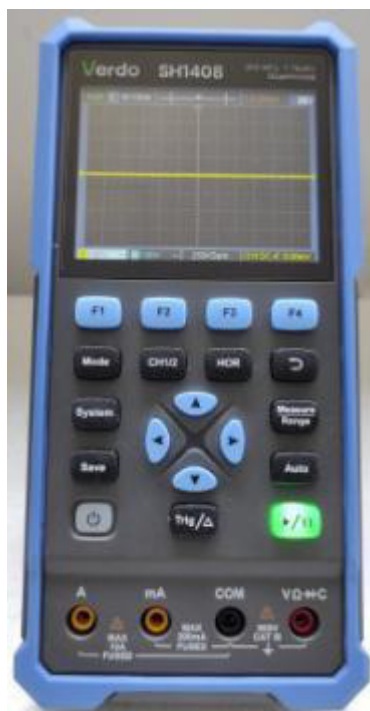
Рисунок 1 – Общий вид осциллографов, передняя панель
