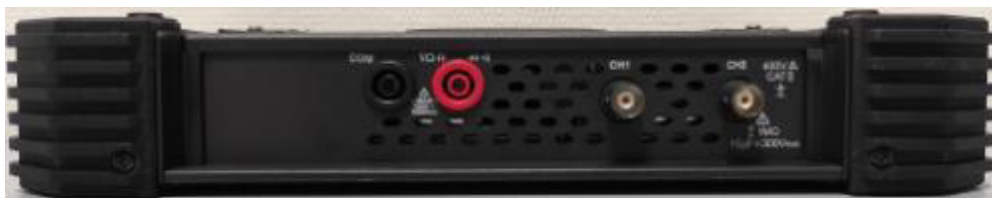
Рисунок 3 – Общий вид осциллографов, верхняя панель двухканальной модификации
