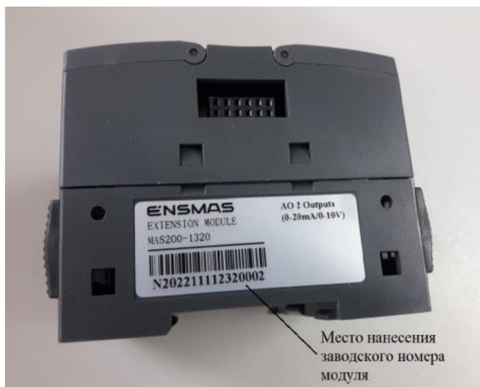
Рисунок 2 – Место нанесения заводского номера на модуль MAS200
