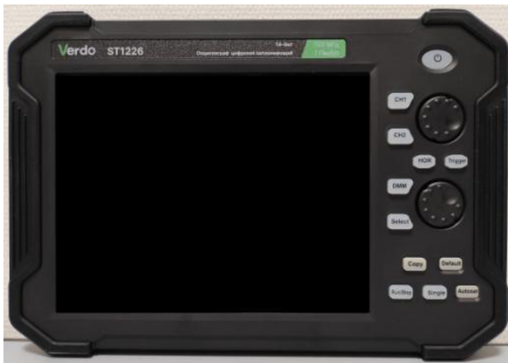
Рисунок 1 – Общий вид осциллографов, передняя панель
