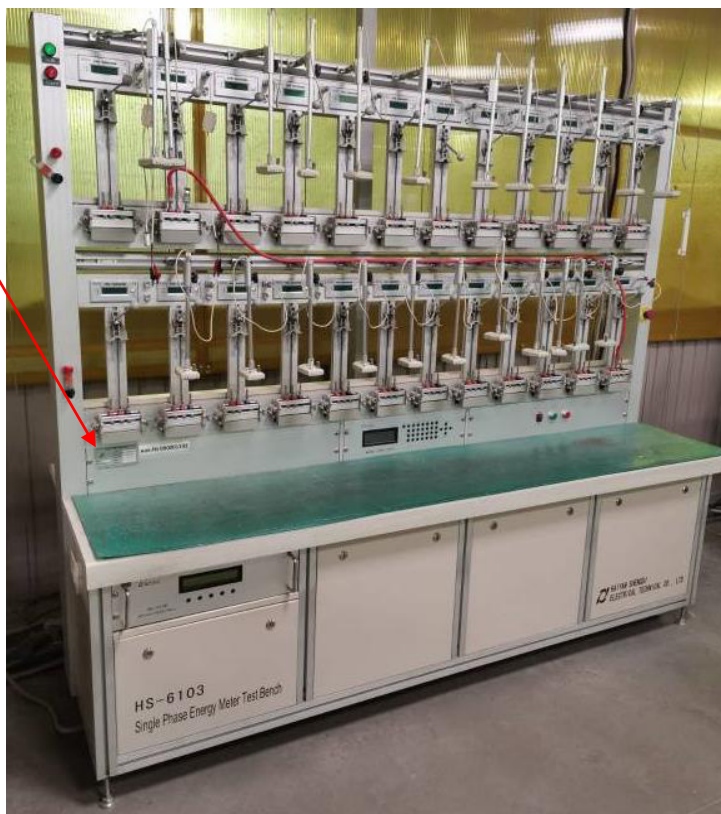
Рисунок 1 – Общий вид установки с указанием места нанесения знака утверждения типа и заводского номера
