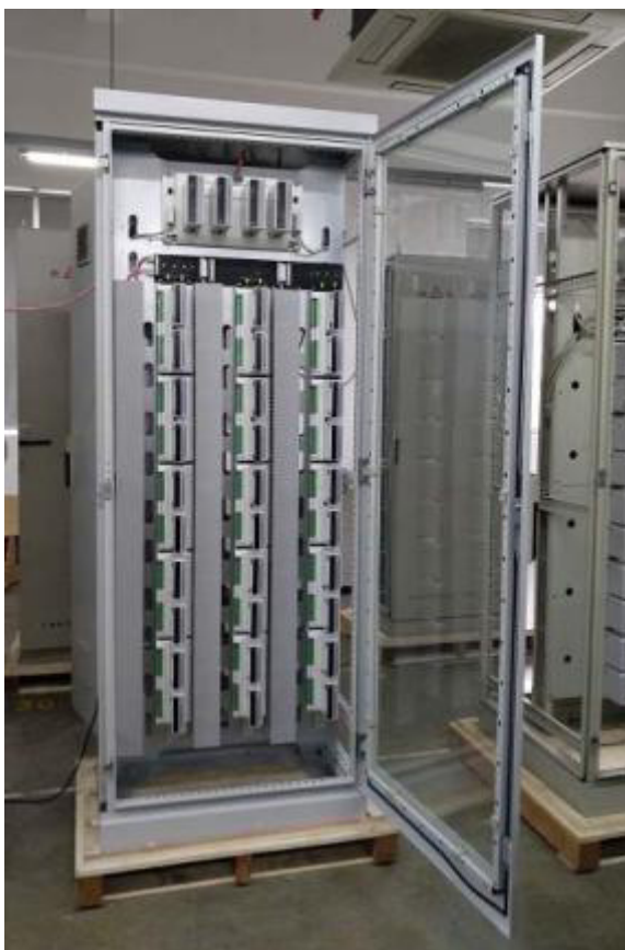
Рисунок 1 - Общий вид стойки модулей MAS8600 в электротехническом шкафу
