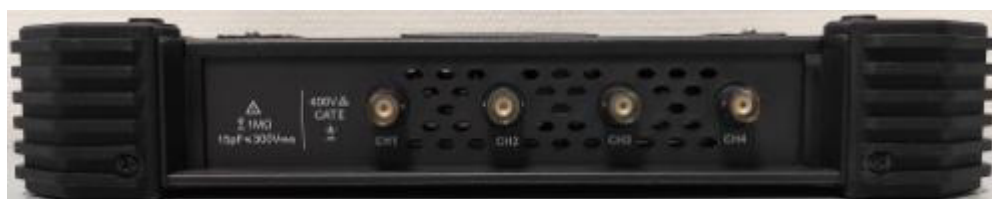
Рисунок 4 – Общий вид осциллографов, верхняя панель четырехканальной модификации
