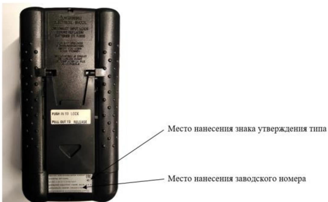
Рисунок 3 - Место нанесения знака утверждения типа и заводского номера модификаций CONBAT RT1000A, CONBAT RT1000B, CONBAT RT1000C
