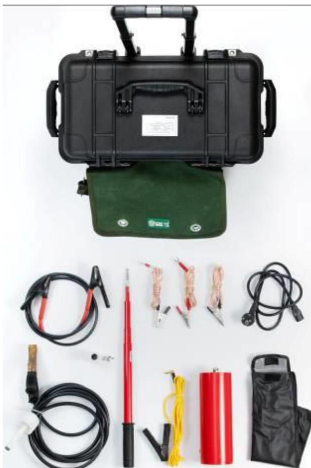
Рисунок 4 – Общий вид установок измерительных высоковольтных Метерон ИСП/М-30П, Метерон ИСП/М-40П, Метерон ИСП/М-60П
