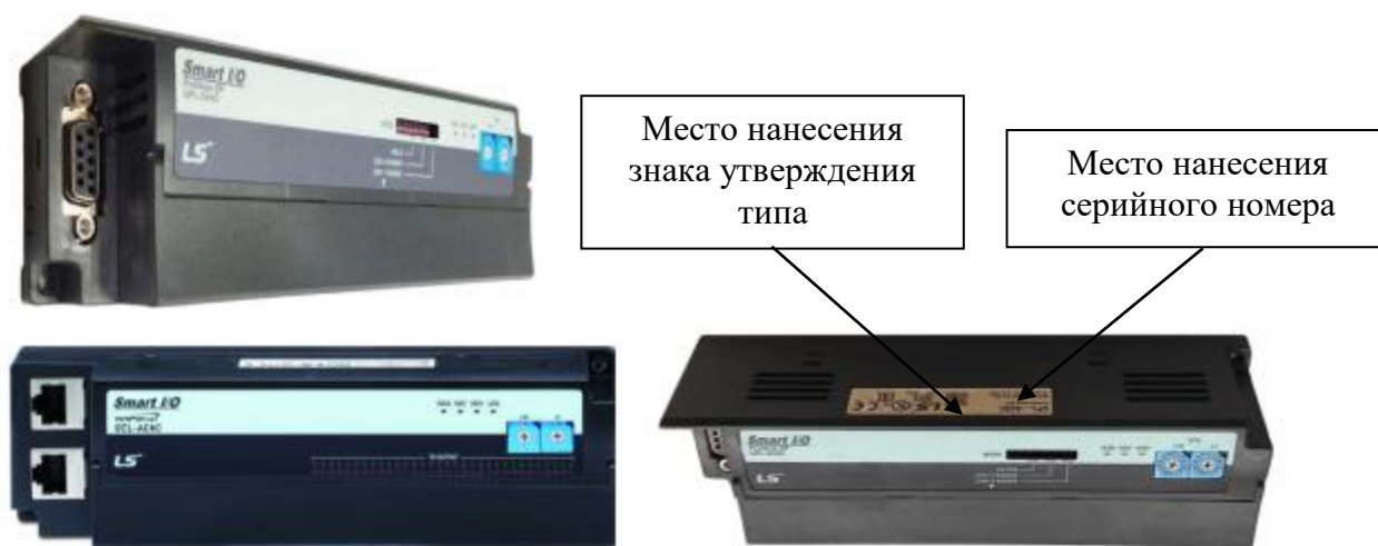
Рисунок 5 - Общий вид преобразователей исполнений GPL-..., GEL-... с указанием места нанесения знака утверждения типа, места нанесения серийного номера
