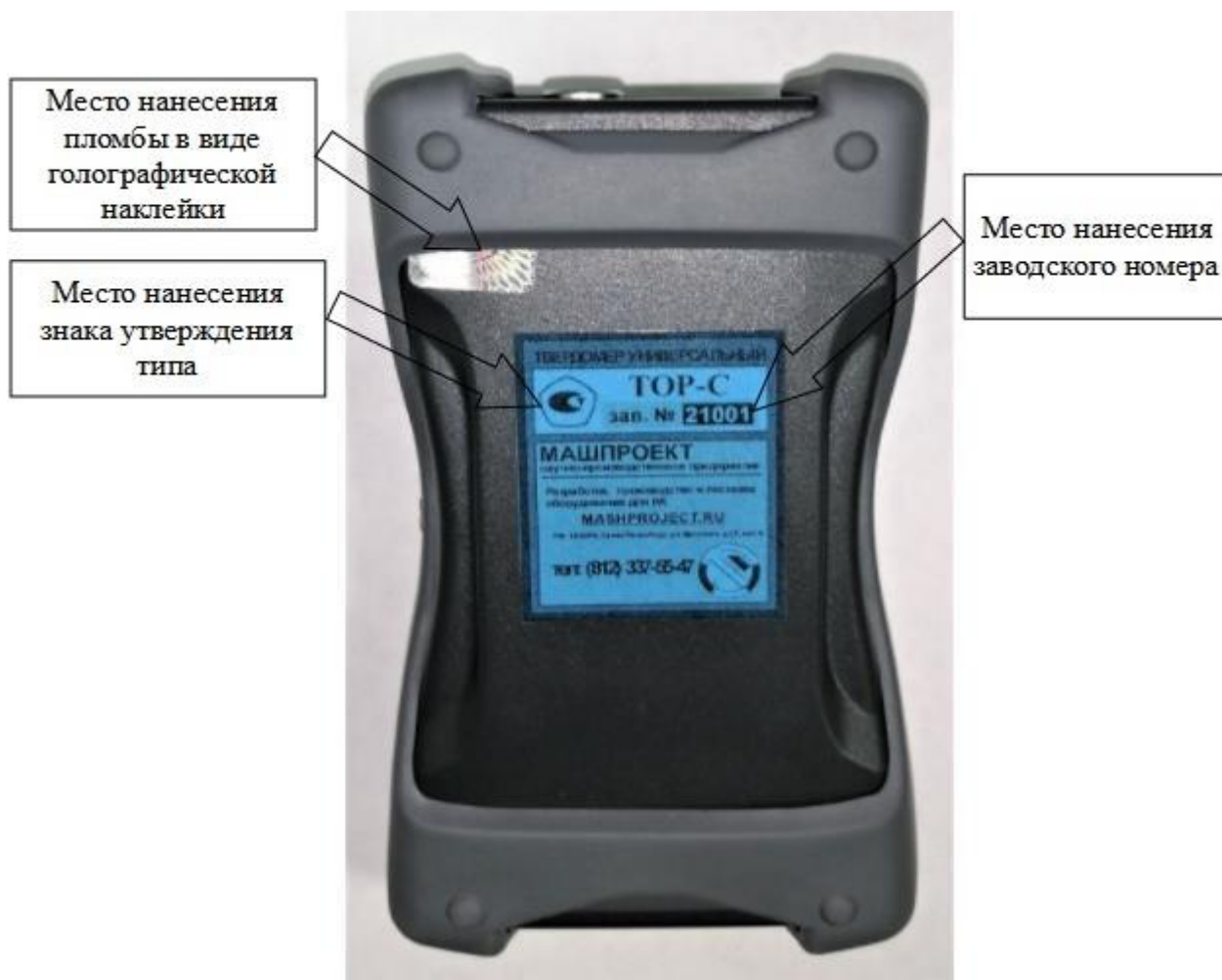
Рисунок 4 – Общий вид твердомеров универсальных с указанием мест пломбировки, нанесения знака утверждения типа и заводского номера
