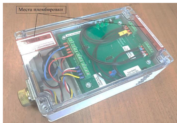
Рисунок 4 – Места пломбирования от несанкционированного доступа
