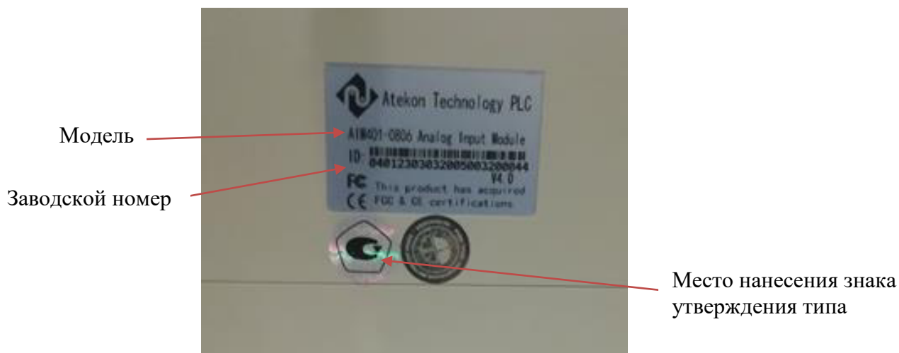
Рисунок 4 – Информационные сведения на корпусе модуля
