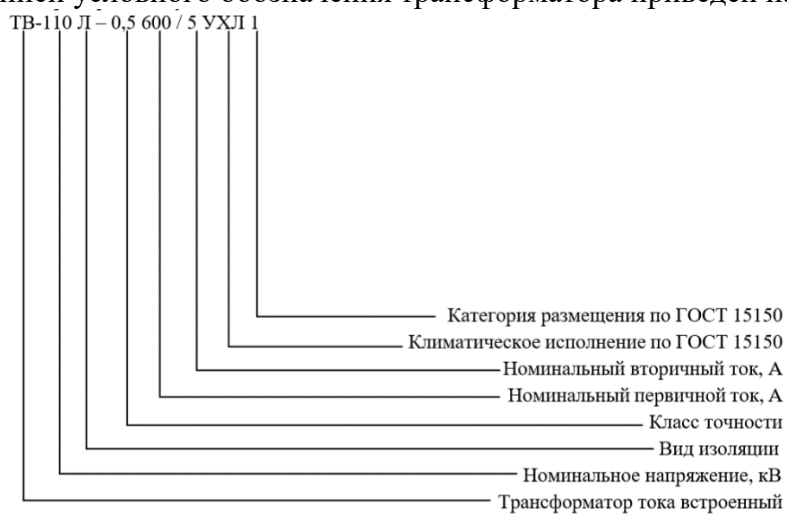
Рисунок 3 - Пример записи условного обозначения трансформатора
