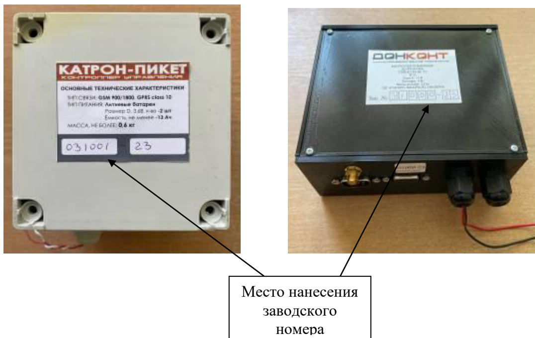
Рисунок 2 – Места нанесения заводского номера и саморазрушающейся наклейки контроллера управления КАТРОН.
